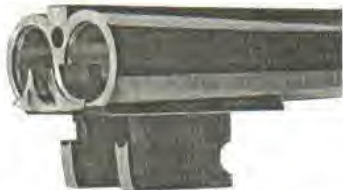
Paralelni donji ključevi ispod svake cijevi, velikih bočnih naliježućih površina, obezbeđuju stabilno povezivanje cijevi i baskule i sprečavaju "rasklimavanje" cijevi lijevo-desno što je karakteristično za klasične ključeve kod duže upotrebe puške.
